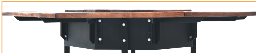
Отверстия в уголке для крепления досок столешницы
